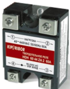
**Твердотельные реле KIPPRIBOR** серии HDH предназначены для управления однофазной электрической нагрузкой от 60 до 120 А. Реле серии HDH изготавливаются с двойным SCR-выходом (два тиристора, наращенных непосредственно на охлаждающей подложке, и разнесенных друг от друга), что позволяет достичь более качественного рассеивания тепла по сравнению с другими типами твердотельных реле, а так же выдерживать номинальные токи на резистивной нагрузке длительный период времени.
