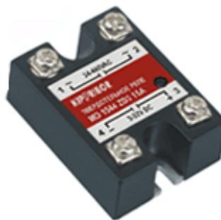
Твердотельные реле KIPPRIBOR серии MD предназначены для управления однофазной электрической нагрузкой от 5 до 15 А. Реле серии MD изготавливаются в корпусе уменьшенного размера по сравнению со стандартными типами твердотельных реле. Малые габариты позволяют значительно экономить место при монтаже. Реле имеют симисторный выход (TRIAC).
