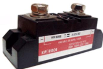
**Твердотельные реле KIPPRIBOR** серии BDH предназначены для управления мощной однофазной электрической нагрузкой от 100 до 250 А. Реле серии BDH изготавливаются с двойным SCR-выходом (два тиристора, наращенных непосредственно на охлаждающей
