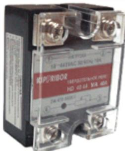
Твердотельные реле KIPPRIBOR серии HD предназначены для управления однофазной электрической нагрузкой от 10 до 80 А. Реле серии HD изготавливаются в нескольких модификациях и отличаются типом управляющего сигнала и родом тока коммутируемой цепи. Твердотельные реле с управлением переменным резистором позволяет вручную регулировать напряжение нагрузки. Реле имеют симисторный выход (TRIAC).
