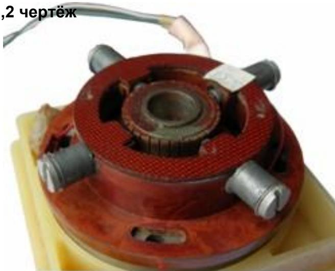
Тахогенератор ТП75-20-0,2 и Тахогенератор ТП80-20-0,2 фото
