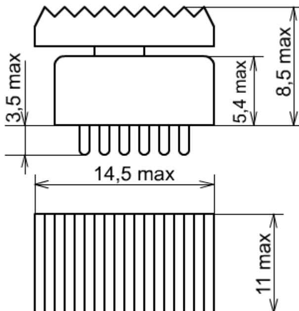
Переключатель не имеет ключа первого вывода, так как допускает монтаж с поворотом на 180° с сохранением логики работы.
