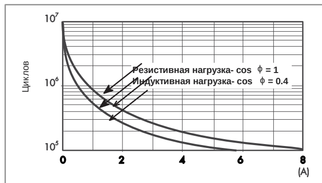
F 40 - Электрическая долговечность (AC) при ном. нагрузке Типы 40.52
