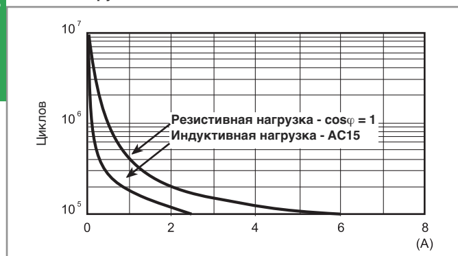
F 7S16 - Электрическая долговечность (AC) при ном. нагрузке - 7S.14 / 7S.16
