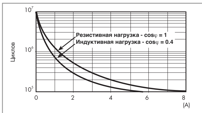
F 50 - Электрическая долговечность (АС) при ном. нагрузке
