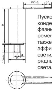
Пусковые и рабочие конденсаторы для однофазных двигателей переменного тока, служат также для улучшения коэффициента мощности светильников с газоразрядными источниками света. (Аналог К78-17).
